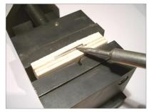
6. Fixiere das Blech jetzt mit dem abgeknickten, unbeschrifteten Rahmenblech im Schraubstock und trenne die Trittroste vorsichtig mit Hilfe der Laubsäge aus dem Rahmen:
